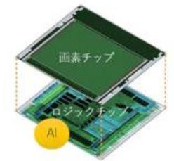
インテリジェントビジョンセンサーの積層構造イメージ
